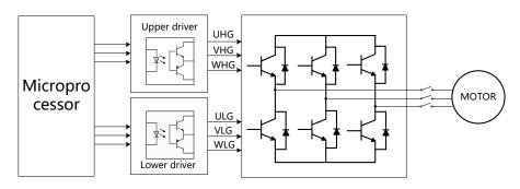
图 B.1 变频器驱动电机原理
