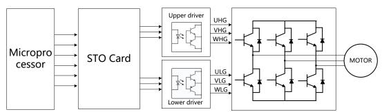
图 B.2 带 STO 功能的系统框图
