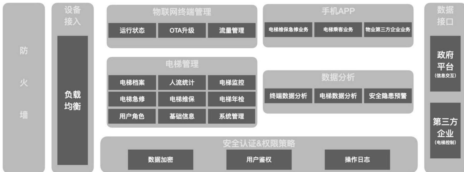
图1 企业级物联网平台架构图
