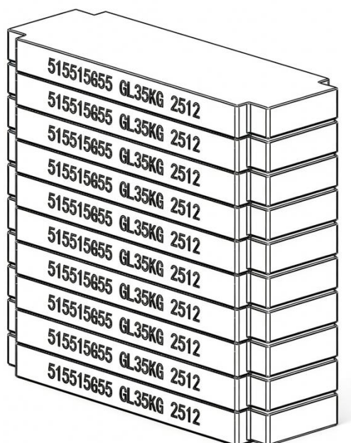
图 3 铸铁对重块堆叠示意图
