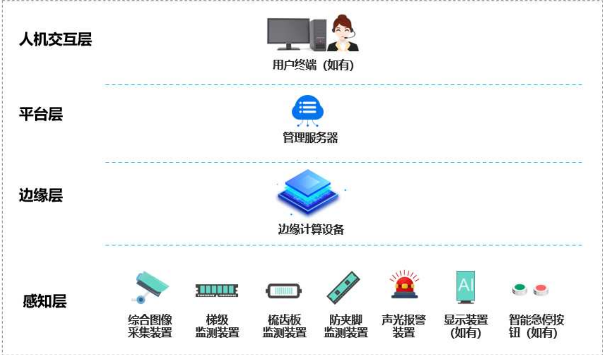
图 1 自动扶梯和自动人行道视觉识别监测系统架构示例图
