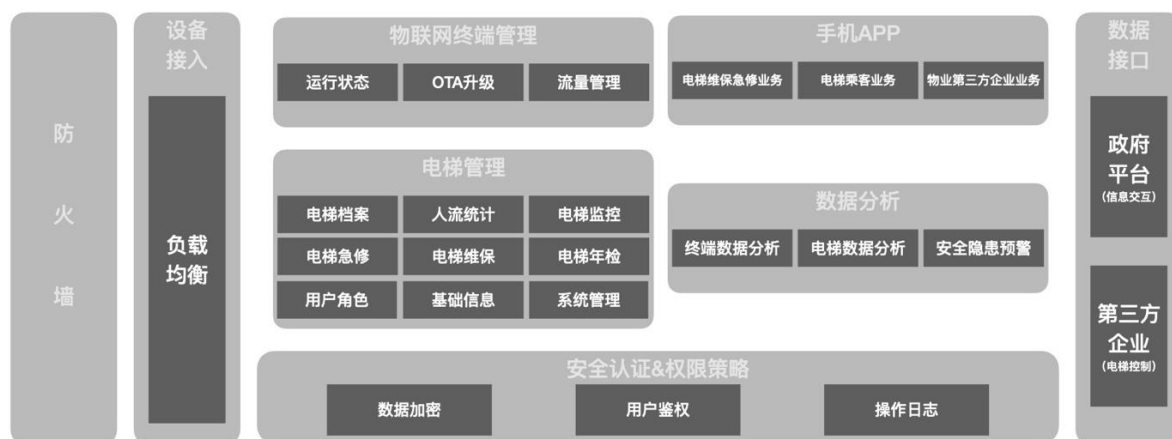
图1 企业级物联网平台架构图
